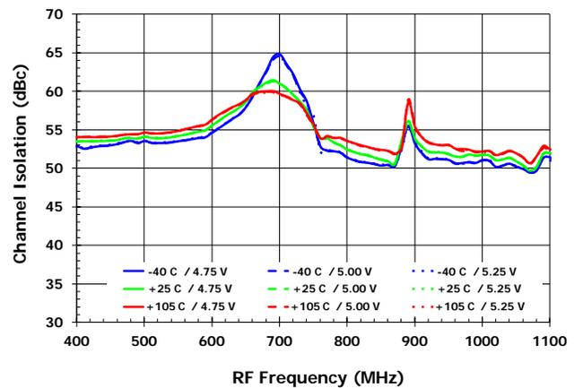
VGA BYPASS OFF: TYPICAL OPERATING CONDITIONS (- 2 -)
