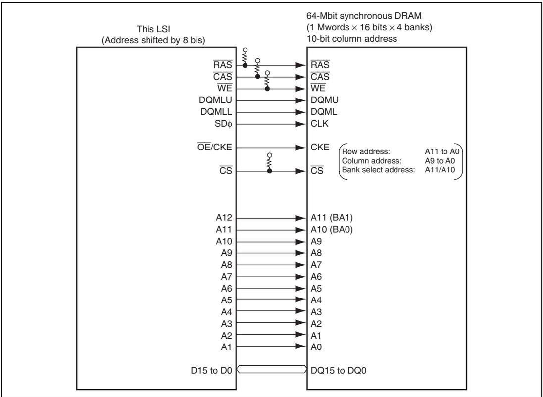
**Figure 9.71 Connection Example of DQM Byte/Word Control**
