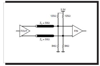
FIGURE 3B. LVPECL OUTPUT TERMINATION
