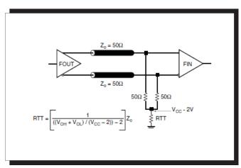
FIGURE 3A. LVPECL OUTPUT TERMINATION
