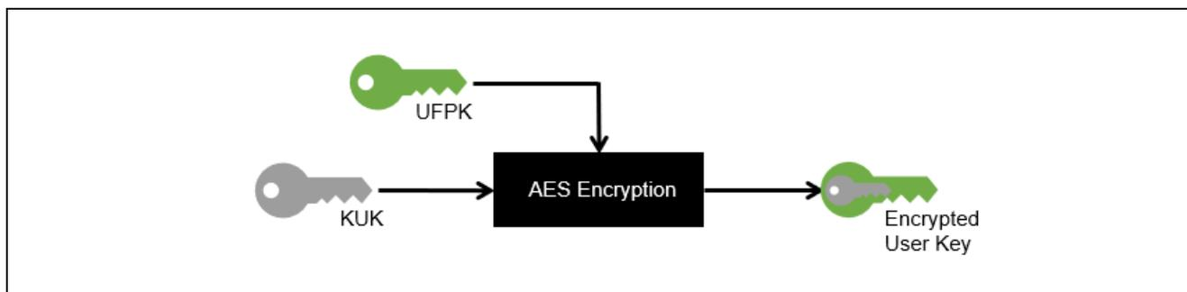
図 1.8 UFPK を使用した KUK のラッピング
