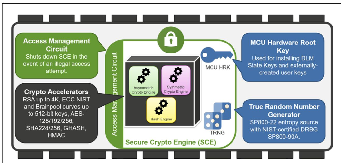
図 1.1 Secure Crypto Engine の概要
