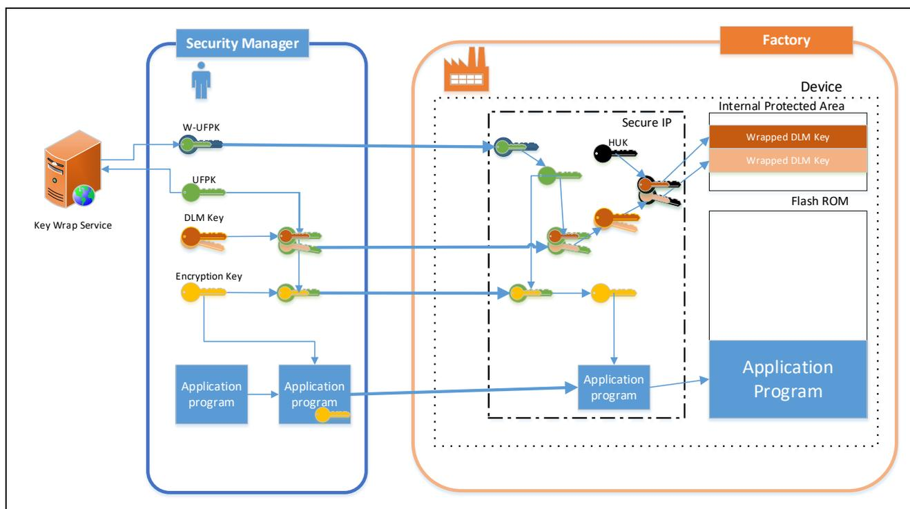
図 1.16 Secure Factory Programming 機能実装 MPU/MPU のシステム例
