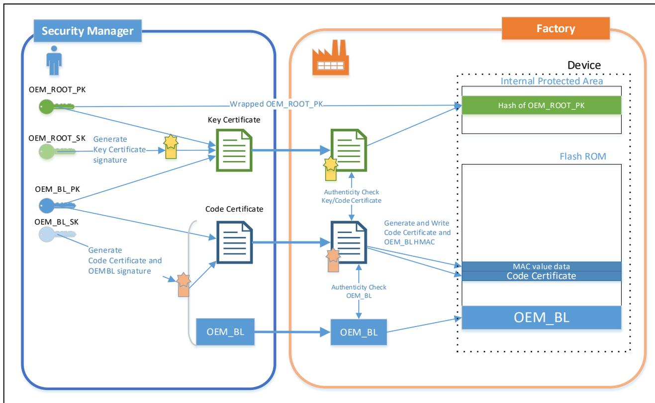
図 1.13 OEM\_BL 工場書き込み時の Authenticity Check
