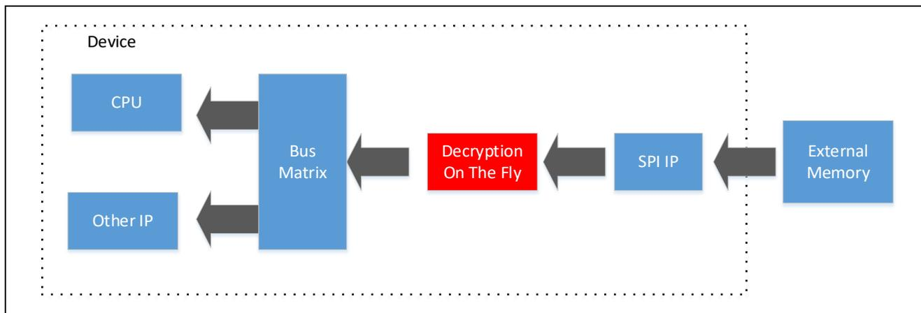
図 1.15 Decryption On-The-Fly 実装 MCU/MPU の内部システムバス例
