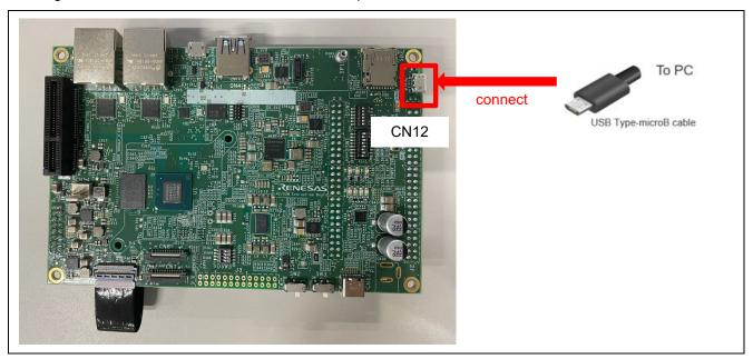
Figure 40: Debug Serial(console output)
